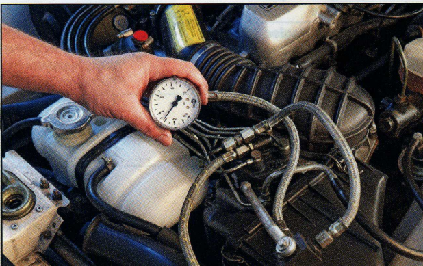
Ruckelt der Motor oder startet er unwillig, ist ein Check der K-Jetronic angebracht. Hier wird gerade eine Druckprüfung vorgenommen
