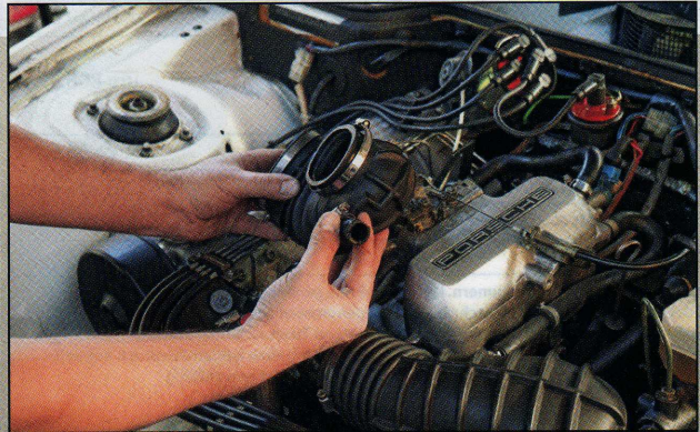
Manchmal zieht der Motor Falschluff. Es lohnt sich deshalb, ab und zu die Schläuche des Einspritz-Systems nach Rissen abzusuchen
